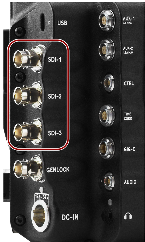
Figure :12G SDI公头BNC连接器的正面( 看着摄像机的背面) 。
